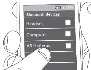
El altavoz emite un sonido cuando termina de sincronizar y conectarse al teléfono inteligente. La luz indicadora en la parte superior del altavoz se enciende en color azul continuo.
