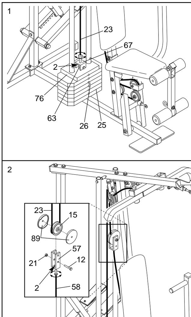
**HINWEIS: Überprüfen Sie vor jedem Gebrauch alle Kabel. Falls das Kabel öfters von der Rolle abrutscht, kann es sein, dass sich das Kabel verdreht. Entfernen Sie das Kabel zunächst und legen Sie es erneut ein.**
