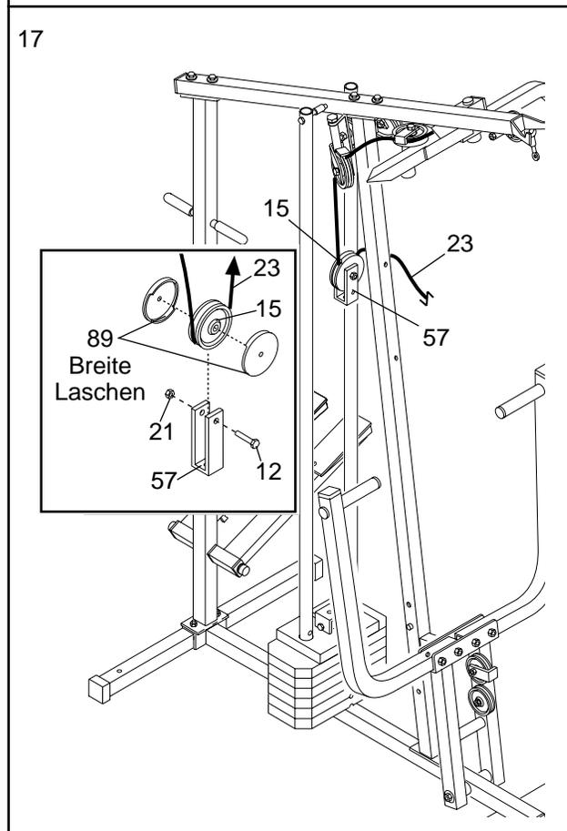
18. Führen Sie das lange Kabel (23) um die 3 1/2" Rolle (15), welche an der Klammer der oberen Rahmenstange (55) befestigt ist. Ziehen Sie den 3/8" x 2" Bolzen (12) und die 3/8" Nylon-Verschlussmutter (21) fest. **(Anmerkung: Die Rolle ist schon montiert. Sie ist hier separat gezeigt, um die Identifizierung der Teile zu erleichtern). Vergewissern Sie sich, dass das Kabel in der Rille der Rolle verläuft und dass sich Kabel und Rolle leicht bewegen können.**
