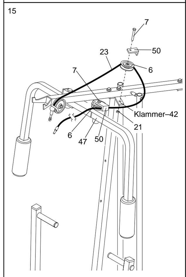
16. Führen Sie das lange Kabel (23) um die "V"-Rolle (6) am rechten Griffrohr (48).
