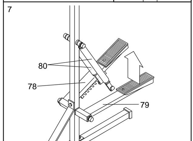
Heben Sie das rechte Pedal (78) an und lassen Sie es am Haken am unteren Ende des rechten Widerstandszyinders (80) aufliegen. **Vergewissern Sie sich, dass sich die Haken unter beiden Pedalen in derselben Stellung befinden.**
