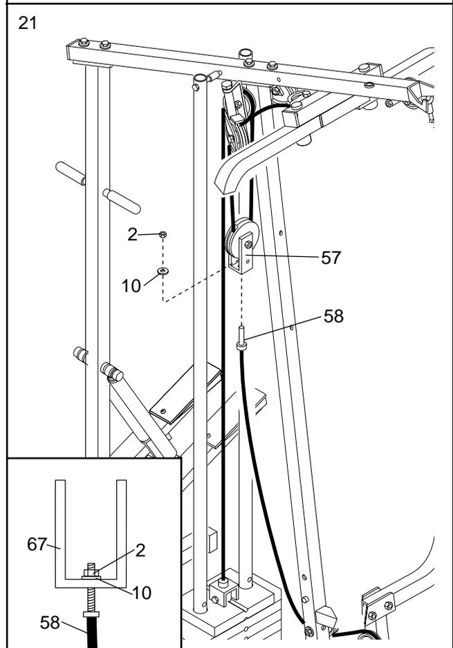
22. Befestigen Sie das lange Kabel (23) mit einer 1/4" Nylon-Verschlussmutter (2) und einer 1/4" Unterlegscheibe (10) an der kleinen "U"-Klammer (67). **Ziehen Sie die Nylon-Verschlussmutter noch nicht ganz an. Sie sollte nur ein paar Umdrehungen auf das Ende des Kabels gedreht werden, so dass nur ein paar Gewinde von der Nylon-Verschlussmutter hervorstrecken, wie im Nebenzeichnung gezeigt.**
