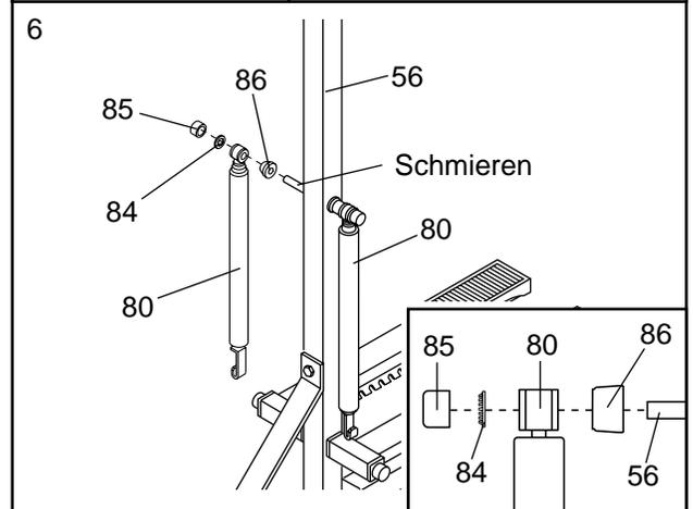
Klopfen Sie gleicherweise einen 5/8" Spannring (84) und einen 5/8" runden Deckel (85) auf die linke Zylinderachse.
