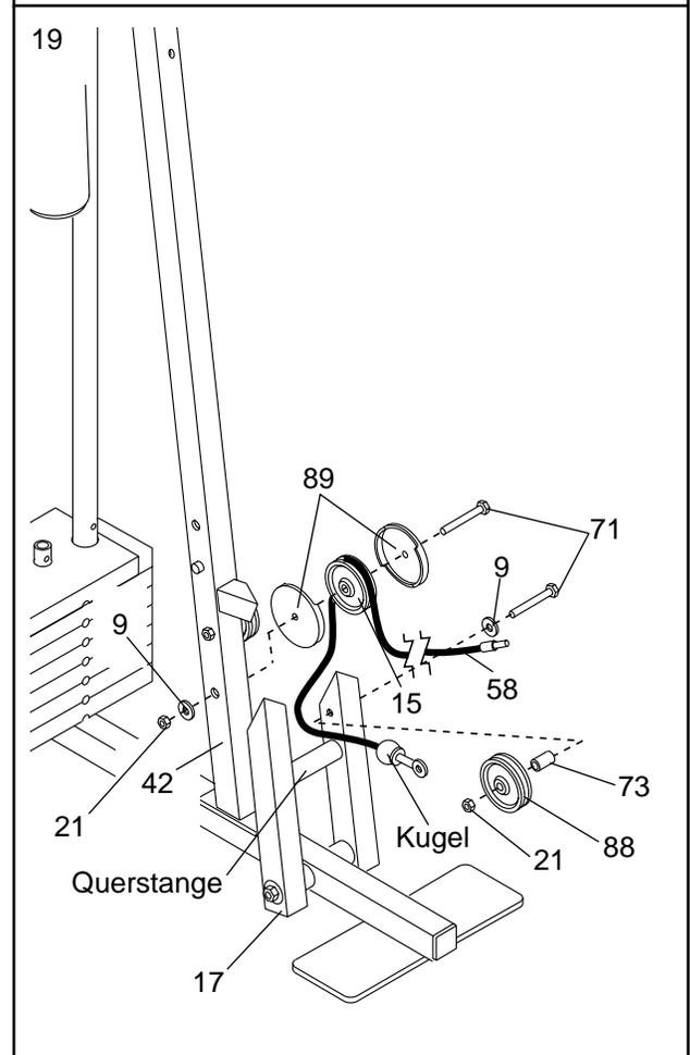
20. Führen Sie das kurze Kabel (58) um die 3 1/2" Rolle (15), die am oberen Loch der Pressrahmen (17) befestigt ist. **Achten Sie darauf, dass die Kabelklappe (66) in der 15-Uhr-Position befindet und dass das Kabel so um die Rolle geführt wird, wie angezeigt.** Ziehen Sie die 3/8" Nylon-Verschlussmutter (21) und den 3/8" x 3 3/4" Bolzen (nicht abgebildet) fest.
