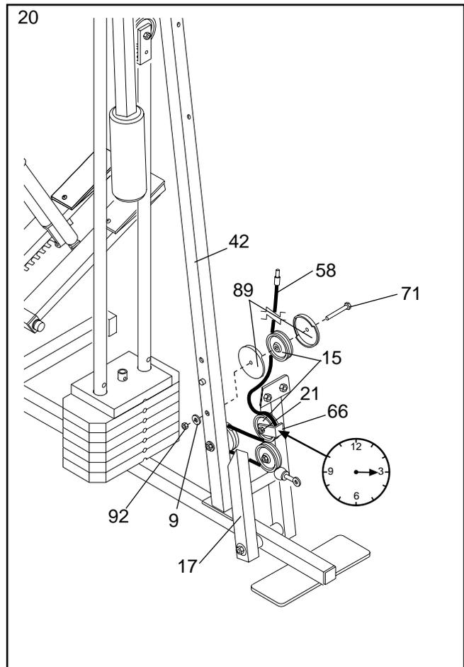
21. Befestigen Sie das Ende des kurzen Kabels (58) mit einer 1/4" Nylon-Verschlussmutter (2) und einer 1/4" Unterlegscheibe (10) an der langen "U"-Klammer (57). **Ziehen Sie die Nylon-Verschlussmutter noch nicht ganz an. Sie sollte nur ein paar Umdrehungen auf das Ende des Kabels gedreht werden, wie im Nebenzzeichnung angezeigt wird.**
