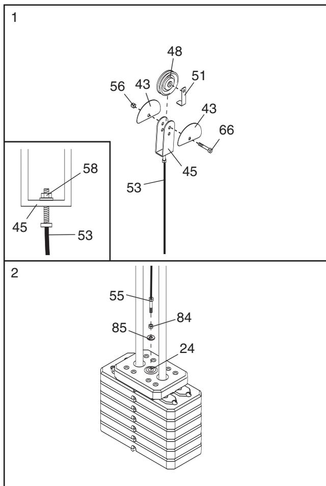
**Ne tendez pas les câbles de manière extrême; le poids supérieur sera surélevé de la pile des poids. Si un câble a tendance à glisser des poulies, il est possible qu'il est entortillé sur lui-même. Retirez le câble et réinstallez-le.** Si les câbles ont besoin d'être remplacés, voir **POUR COMMANDER DES PIÈCES DE RECHANGE** au dos du manuel.
