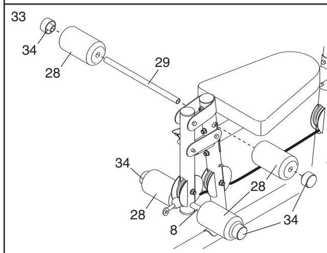
Glissez deux Petits Coussins en Mousse (28) sur Levier pour Jambes (8). Fixez deux Embouts en Mousse (34) sur le Levier pour Jambes.
