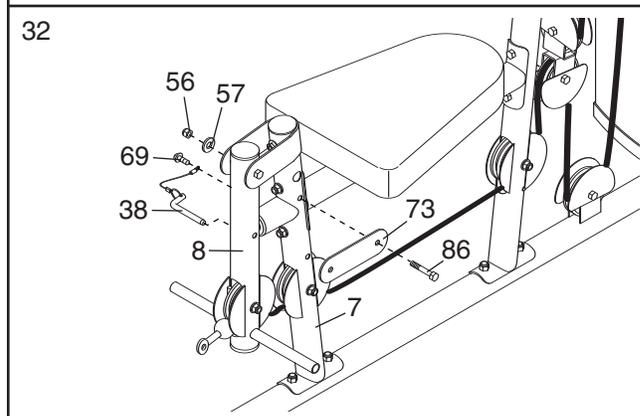
Attachez la Goupille du Levier pour Jambes (38) à la Jambe Avant (7) à l'aide d'une Vis Auto-Taraudeuse de M4 x 20mm (69). Insérez la Goupille du Levier pour Jambes dans le Levier pour Jambes (8) et la Plaquette Frein (73).
