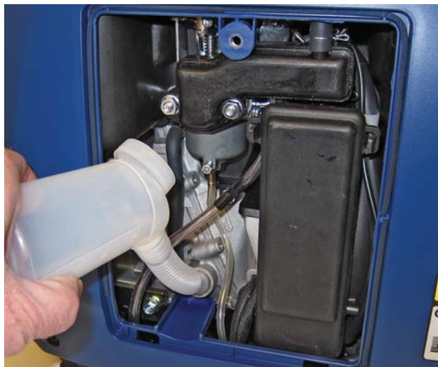
Figura 37 – Procedimiento para agregar el aceite del motor
