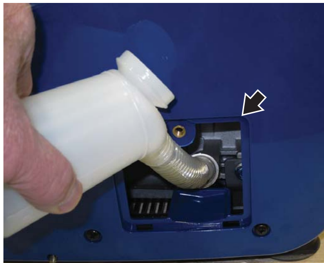
Figura 24 – Procedimiento para agregar el aceite del motor
