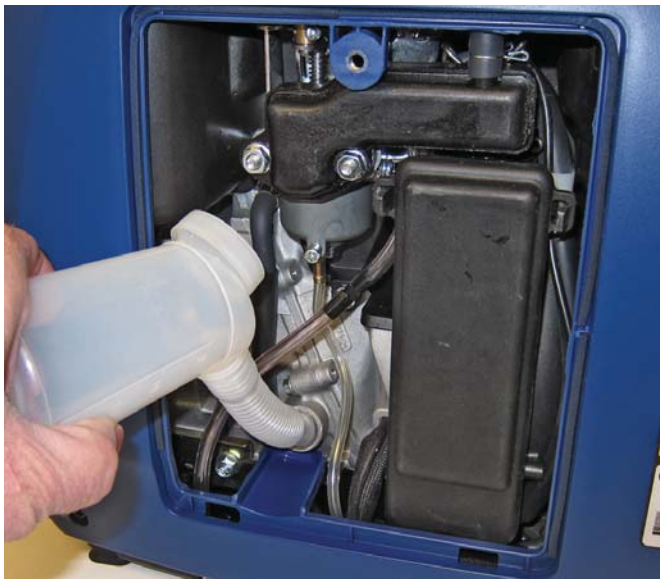
Figura 19 – Procedimiento para agregar el aceite del motor
