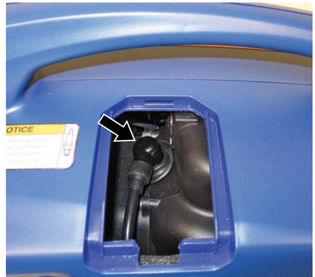
Figura 49 – Procedimiento para retirar el capuchón de la bujía de encendido (se muestra el modelo WH1000i)
