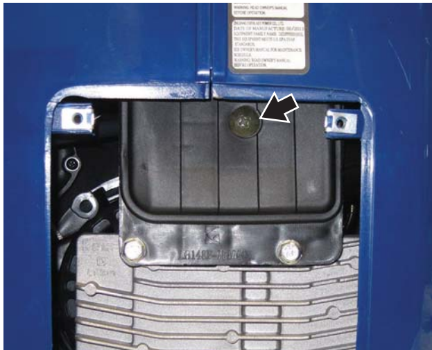
Figura 43 – Cubierta del filtro de aire
