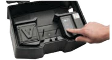
5. En fermant le couvercle, un voyant DEL jaune sur le dessus de la boîte commence à clignoter plus rapidement au fur et à mesure de l'étalonnage. Une fois l'étalonnage terminé, le voyant jaune s'éteint et laisse place à un voyant vert.
