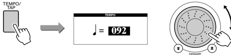
Puede volver al tempo original pulsando simultáneamente los botones [+] y [-]. Presione el botón [EXIT] (salir) para volver a la pantalla MAIN (principal).
