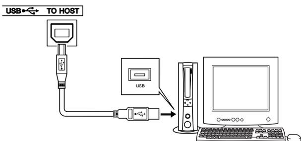
Si conecta el terminal USB del instrumento al terminal USB de un ordenador, podrá transferir datos de interpretaciones y archivos de canciones entre ambos dispositivos (página 99). Para utilizar las funciones de transferencia de datos USB debe hacer lo siguiente:
