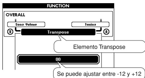
**3** Utilice el selector para ajustar el valor de transposición entre -12 y +12.
