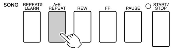
**3** La sección A-B especificada de la canción se reproducirá de forma repetida. Puede detener la repetición de la reproducción en cualquier momento pulsando el botón [A-B REPEAT].
