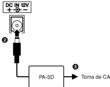
Realice todas las conexiones necesarias **ANTES** de encender el instrumento.
