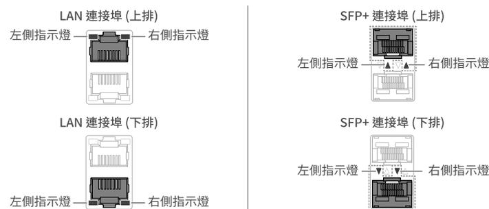
顯示模式分成多種，包括「LINK/ACT」模式（顯示連結狀態及連線速度）、「STATUS 模式」（顯示錯誤狀態）及「OFF 模式」（連接埠指示燈關閉）。
