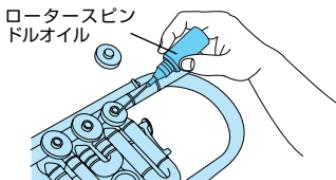
2. ローター回転軸と受軸にも、ロータースピンドルオイルを注油します。キャップを締めたたら、オイルがなじむようにレバーを2~3回動かします。
