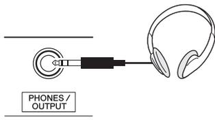
Aquí se puede conectar un par de auriculares estéreo con una clavija para auriculares estéreo de 1/4" con el fin de realizar una monitorización cómoda. Los altavoces se desconectan automáticamente al insertar una clavija en esta toma.
