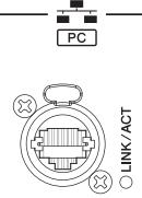
Anschluss für einen Computer für die externe Steuerung
