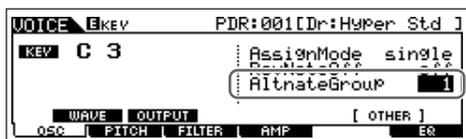
**4 Schlagen Sie die Taste an, die „Hi-Hat Close“ (Hi-Hat geschlossen) entspricht, und stellen Sie dieselbe „Alternate Group“ wie in Schritt 3 ein.**
