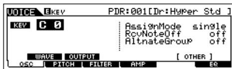
**3 Schlagen Sie die Taste an, die „Hi-Hat Open“ (Hi-Hat geöffnet) entspricht, und setzen Sie „Alternate Group“ (Alternierende Gruppe) auf „1“.**
