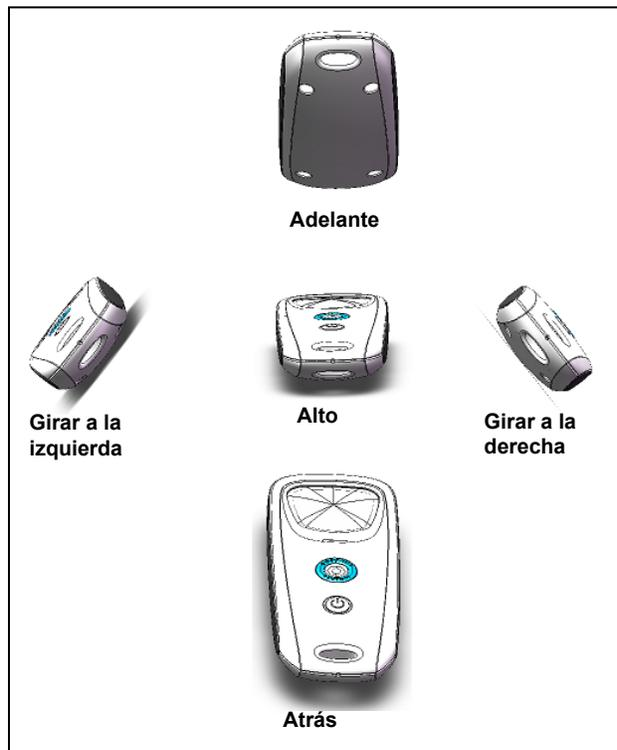
Figura 21. Comandos direccionales del control remoto
