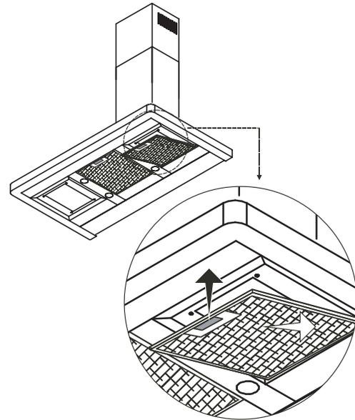
**Replacing Metal Filters**
