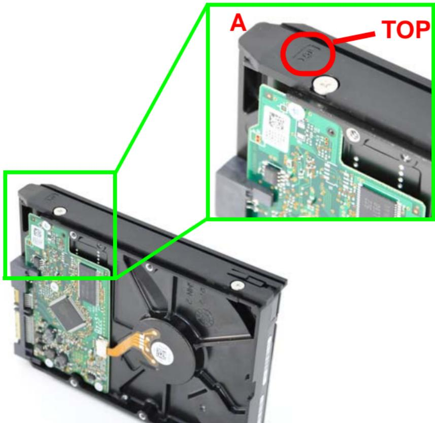
4. Führen Sie die Festplatte wie abgebildet an einen NSA-Schacht heran, und schieben Sie sie vollständig in den Schacht ein.
