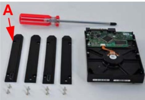
Coloque el soporte con la etiqueta **TOP** como se muestra. Apunte con el extremo mellado hacia el extremo de la conexión del disco o discos duros (**A**). Utilice dos de los tornillos incluidos para colocar el soporte del chasis al disco duro. Coloque el soporte **BOTTOM** en el otro lado del disco duro de manera similar.
