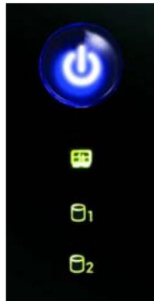
*Om de NSA uit te zetten, drukt u op de aan/uit knop en houdt deze ingedrukt totdat u een piep hoort. Laat de knop dan los.*
