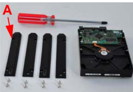
Bevestig de beugel die is gemarkerd als **TOP** (BOVENAAN) zoals weergegeven. Richt het taps toelopende uiteinde op de aansluiting van de harde schijf (**A**). Gebruik twee van de meegeleverde schroeven om de bevestigingsbeugel aan de harde schijf te bevestigen. Bevestig de beugel die is gemarkerd als **BOTTOM** (ONDERAAN) op dezelfde wijze aan de andere kant van de harde schijf.
