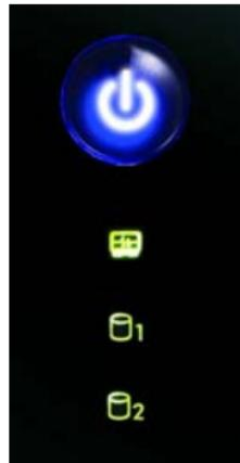
*Um das NSA auszuschalten, drücken Sie so lange auf die Ein/Aus-Taste, bis ein Signalton zu hören ist. Lassen Sie dann die Taste los. Der Gerät wird dann sicher herunter gefahren.*
