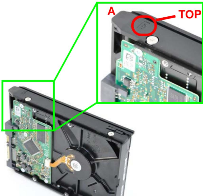
4. De harde schijf uitlijnen met een NSA sleuf zoals weergegeven en schuif het helemaal in de sleuf.
