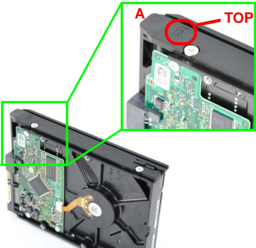
4. Allineare il disco rigido a una bay NSA come mostrato in figura e farlo scorrere all'interno della bay fino a inserirlo completamente.
