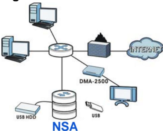
Ovanför visas NSA i ett hemmanätverk. Användare säkerhetskopierar och delar data på NSA. DMA-2500 spelar upp NSA:s mediefiler på TV:n. En USB-hårddiskenhett ger extra lagringsutrymme och filer kopieras direkt från USB-minnet till NSA med knappen **COPY/SYNC**.
