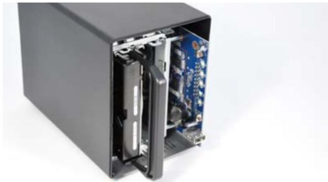
3. Halten Sie den NSA in den Händen, und drücken Sie mit dem Daumen gegen die Vorderseite des Chassis. Ziehen Sie dann die Festplatte heraus.
