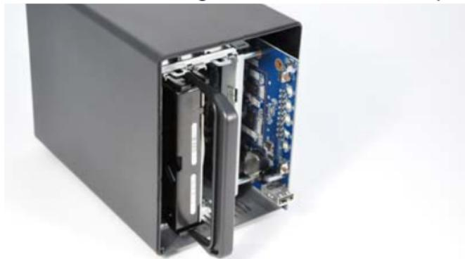
3. Houd de NSA vast en druk uw duim tegen de voorkant van het chassis en trek de harde schijf eruit.
