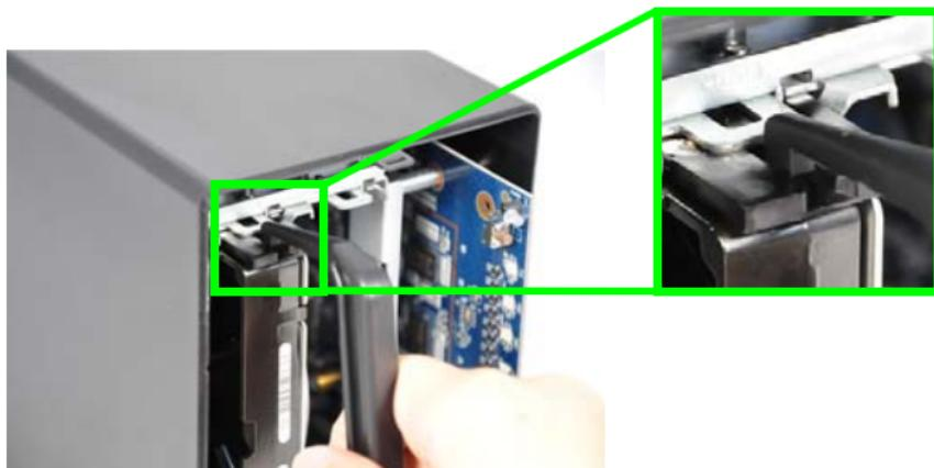
2. Empuje el otro extremo del asa en la muesca de la parte inferior del soporte del chasis. Compruebe que el asa quede fija en ambas muescas.
