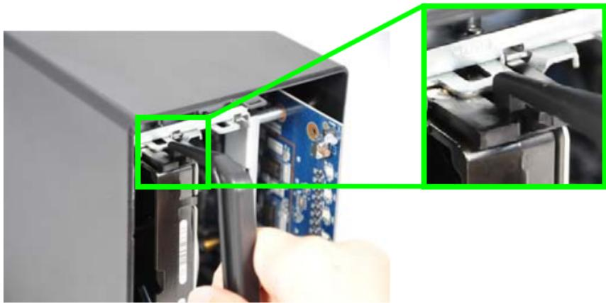
2. Premere l'altra estremità nella scanalatura sulla staffa dello chassis inferiore. Assicurarsi che la maniglia sia bloccata in entrambe le scanalature.
