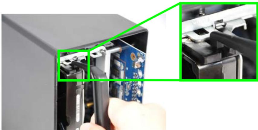
2. Poussez l'autre extrémité de la poignée dans l'encoche du bas du support du châssis. Vérifiez que la poignée est bien enclenchée dans les deux encoches.
