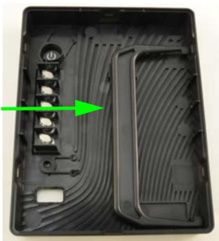
1. Inserire un'estremità della maniglia nella scanalatura della staffa dello chassis superiore.
