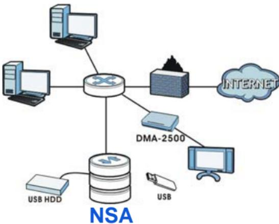
Ci-dessus se trouve le NSA dans un réseau domestique. Les utilisateurs sauvegardent et partagent les données sur le NSA. Le DMA-2500 lit les fichiers média du NSA sur le téléviseur. Un disque dur USB
