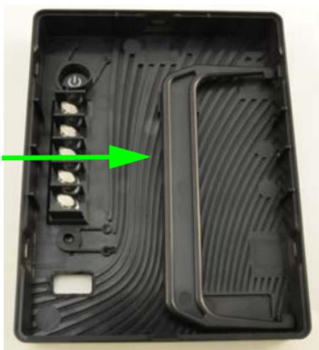
1. Placez une extrémité de la poignée dans l'encoche du haut du support du châssis.
