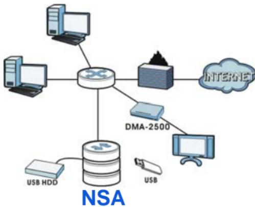
In de bovenstaande afbeelding bevindt zich de NSA in uw thuisnetwerk. Gebruikers maken een backup en delen gegevens op de NSA. De DMA-2500 speelt de mediabestanden van de NSA op de TV. USB harde
