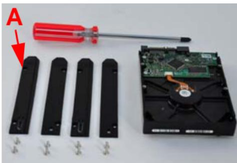
Befestigen Sie die Chassishalterung mit den zwei
