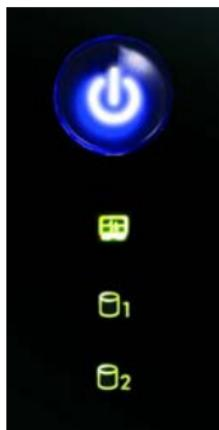
*Du stänger av NSA genom att trycka in och hålla kvar strömknappen tills du hör en signal. Sedan släpper du knappen.*
