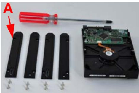
Anslut fästet märkt **TOP** (topp) enligt bild. Rikta den avsmalnande änden mot hårddiskens anslutningsdel (**A**). Använd två av de medföljande skruvarna för att ansluta chassifästet till hårddisken. Anslut fästet märkt **BOTTOM** (botten) på andra sidan av hårddisken på samma sätt.
