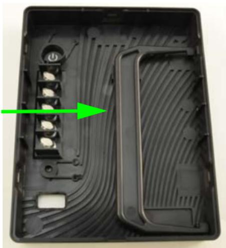
1. Setzen Sie ein Ende des Griffes in die obere Rille der Chassis-Halterung.
