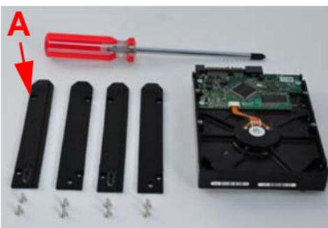
Attachez le support du **TOP** (HAUT) comme illustré. Pointez l'extrémité conique vers le connecteur du disque dur. Utilisez deux des vis fournies pour fixer le support de montage sur le disque dur. Attachez le support du **BOTTOM** (BAS) sur l'autre côté du disque dur de la même manière.
