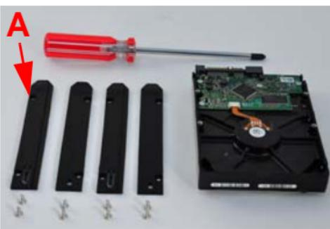
Attaccare la staffa con etichetta **TOP** (SUPERIORE) come mostrato in figura. Puntare l'estremità sottile verso l'estremità di collegamento del disco rigido (**A**). Utilizzare due viti di quelle fornite a corredo per fissare la staffa dello chassis al disco rigido. Attaccare allo stesso modo la staffa **BOTTOM** (INFERIORE) all'altro lato del disco rigido.
