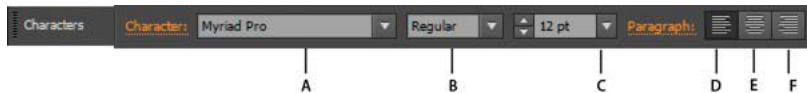
A Font B Font Style C Font Size D Align left E Align center F Align right
