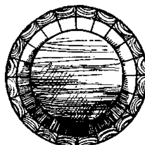
Fig. 121 — O tanoeiro coloca todas as aduelas com a parte dura para fora, a fim de adaptá-las à forma circular pela contração das mesmas.
