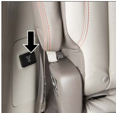
115 Volt Power Inverter
