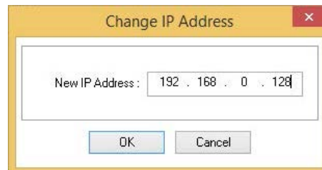
Imagen 201: Dirección IP del controlador de seguridad
