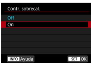
Ajuste en [On] para conservar la carga de la batería y ayudar a prevenir el sobrecalentamiento de la cámara mientras espera a disparar.
