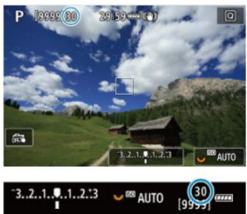
La ráfaga máxima aproximada se muestra en la esquina superior izquierda de la pantalla de disparo y la esquina inferior derecha del visor.
