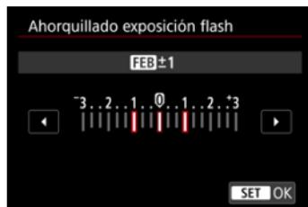
Los flashes Speedlite equipados con ahorquillado de la exposición con flash (FEB) pueden cambiar automáticamente la potencia del flash externo, puesto que se realizan tres tomas a la vez.
