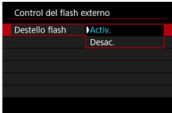
Para activar la fotografía con flash, ajústelo en [Activ.]. Para activar solamente la luz de ayuda al AF del flash Speedlite, ajuste [Desac.].
