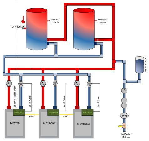
DHW METHOD 3: DHW Heating ONLY using a Header sensor input, Multiple Boilers, Reverse Return.
