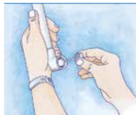
Modo de montar el PVC: 1. Coloque la cola dentro del accesorio y afuera del tubo.
