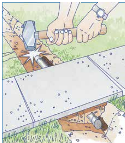
Conecte el tubo por debajo de una vereda o entrada para vehículos tapando los extremos de un tubo galvanizado y martillándolo para hacerlo pasar de un lado al otro.
