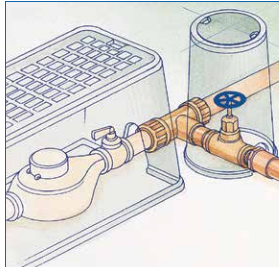
Punto de conexión en climas sin temperaturas bajo cero: Utilice una T de compresión de cobre para conectar su sistema de riego al suministro de agua..
