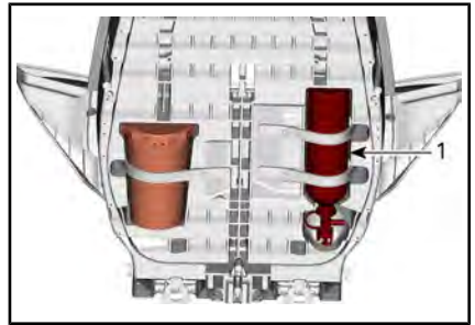
1. Extintor de incendios
