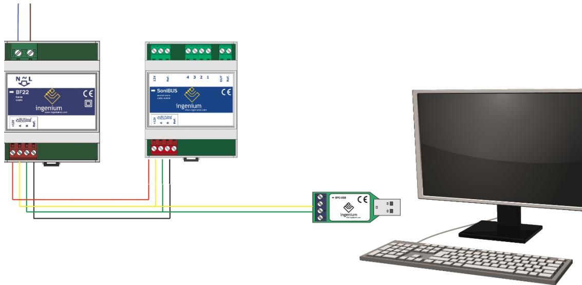
**NOTA:** NO ES NECESARIA LA COLOCACIÓN DE LA FUENTE DE ALIMENTACIÓN SI EN LA INSTALACIÓN EXISTE TENSIÓN SUFFICIENTE PARA ALIMENTARLO. PUDIERA SER QUE LA ALIMENTACIÓN PROVenga DE OTROS EQUIPOS COMO 6E6S ,4E4S.....ETC.
