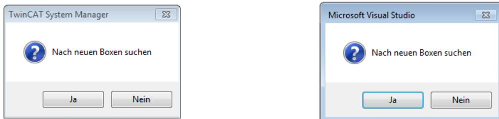
Abb. 105: Scan-Abfrage nach dem automatischen Anlegen eines EtherCAT Gerätes (links: TwinCAT 2; rechts TwinCAT 3)
