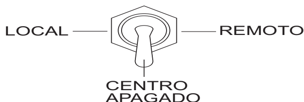
Figura 21. Interruptor de control de bombeo (OFF APAGADO)
