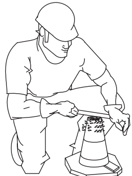
Figura 68-D. Prueba de asentamiento (Remove el exceso de concreto)
