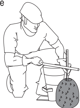
Figura 68-F. Prueba de asentamiento (Midiendo)
