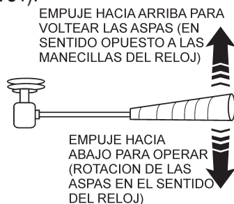
Figura 31. Palanca de control de la revolvedora de la tolva
