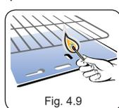
Quando faltar energia elétrica, aproxime uma chama (fósforo aceso) até o orifício no chão do forno (fig. 4.9), pressione e gire o Botão de Controle do Forno para a graduação de temperatura máxima. **Após notar que**
