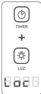
O seu fogão possui um programa especial para bloquear as funções do Painel Digital, impedindo a programação indesejada, podendo ser bloqueado/desbloqueado a qualquer momento conforme descrito abaixo.
