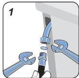
1. Encaixe o anel de vedação e uma das extremidades do tubo flexível metálico e fixe-o na entrada de gás do fogão usando duas chaves ajustáveis (chave inglesa).
