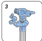
3. Ligar o gás e verificar se existem vazamentos utilizando o detergente líquido viscoso, que garante um melhor desempenho e eficácia do teste.
