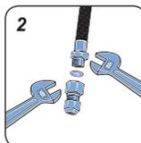
2. Encaixe o anel de vedação na outra extremidade e fixe o tubo flexível metálico no adaptador para “bico de mamadeira”, usando duas chaves ajustáveis.
