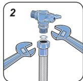
2. Encaixe o anel de vedação na outra extremidade e fixe o tubo flexível metálico no registro de parede com rosca externa 1/2", usando duas chaves ajustáveis.
