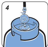
4. Ligar o gás e verificar se existem vazamentos utilizando o detergente líquido viscoso, que garante um melhor desempenho e eficácia do teste.
