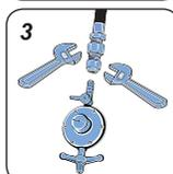
3. Fixe a outra extremidade do adaptador no regulador de pressão com registro tipo “bico de mamadeira”, usando duas chaves ajustáveis.
