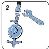
2. Encaixe o anel de vedação na outra extremidade e fixe o tubo flexível metálico no regulador de pressão com registro de rosca externa 1/2", usando a chave ajustável.
