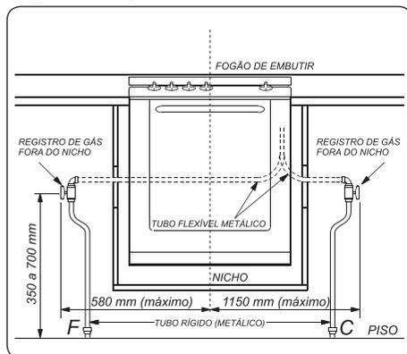
Se o ponto de gás estiver nas posições B ou D, o registro de gás deve ser instalado conforme esquema da figura 4.
