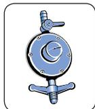
Use sempre um regulador de pressão para qualquer tipo de botijão. A ausência deste pode causar excesso de pressão e vazamento de gás. O regulador de pressão do gás deve ser de 2,75 (2,8) kPa de pressão e, no mínimo, 1kg/h de
