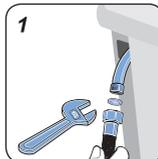
1. Encaixe o anel de vedação e uma das extremidades do tubo flexível metálico e fixe-o na entrada de gás do fogão usando uma chave ajustável (chave inglesa).
