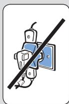
Ligue seu fogão a uma tomada exclusiva, não utilize extensões ou conectores tipo T (benjamim). Esse tipo de ligação pode provocar sobrecarga na rede elétrica, prejudicando o funcionamento do seu fogão e resultando em acidentes.
