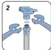
2. Encaixe o anel de vedação na outra extremidade e fixe o tubo flexível metálico no registro de parede com rosca interna 1/2", usando duas chaves ajustáveis.
