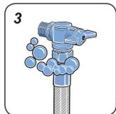
3. Ligue o gás e verifique se existem vazamentos utilizando o detergente líquido viscoso, que garante um melhor desempenho e eficácia do teste.
