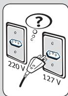
Antes de ligar o seu fogão, verifique se a tensão da tomada onde será ligado é igual à indicada na etiqueta localizada próxima ao plugue (no cabo de alimentação elétrico), ou na etiqueta de identificação do fogão.
