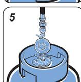
5. Ligue o gás e verifique se existem vazamentos utilizando o detergente líquido viscoso, que garante um melhor desempenho e eficácia do teste.
