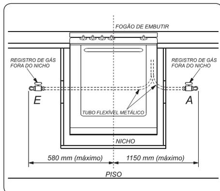
Se o ponto de gás estiver nas posições F ou C, o registro de gás deve ser instalado conforme esquema da figura 3.
