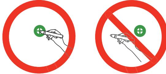
**Observação:** Certifique-se que não está bloqueando o sinal entre a caneta e o receptor de caneta interativa no projetor (próximo à janela de projeção no projetor).
