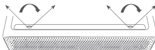
Alcance dos sensores direito e esquerdo: aproximadamente 70 graus
