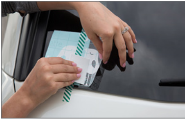
7. Presiona el vinilo contra la superficie. Usa un raspador para eliminar las burbujas.
