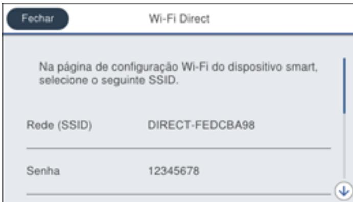
6. Use o seu computador ou dispositivo sem fios para selecionar o nome da rede Wi-Fi (SSID) exibido no visor LCD e depois digite a senha mostrada.
