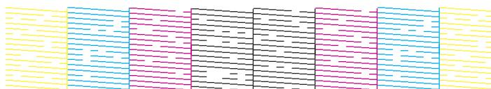
Caso não veja nenhuma melhora após limpar o cabeçote de impressão até 4 vezes, espere pelo menos 6 horas sem imprimir. Depois, tente limpar o cabeçote novamente. Se a qualidade ainda assim não melhorar, entre em contato com o suporte técnico da Epson.
