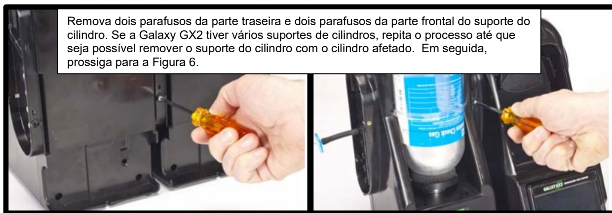
Figura 5 - Remoção de um Suporte do Cilindro de uma Galaxy GX2
