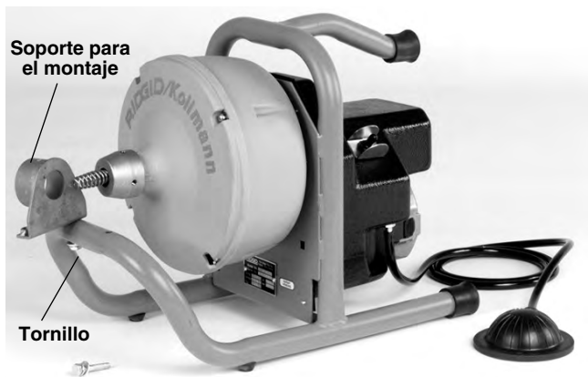
Figura 15 – Soporte para el montaje en posición ABIERTA, lo cual permite acceder al tambor
