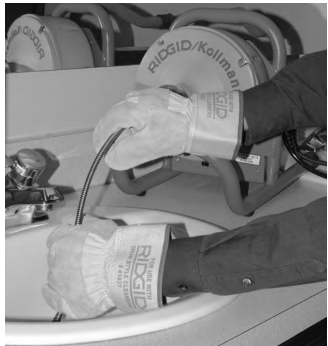
Figure 9 – Avancement manuel du câble
