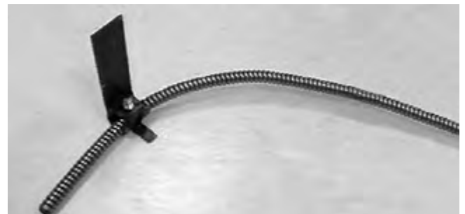
Figura 18 – Brazo torsor acoplado al cable a unas 2 pulgs de su extremo posterior. El cable ha sido curvado en 30°
