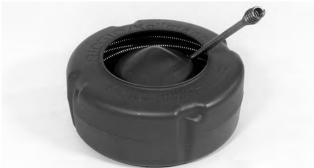
Figura 19 – Enrolle el cable dentro del tambor interior en el sentido contrario al de las manecillas del reloj
