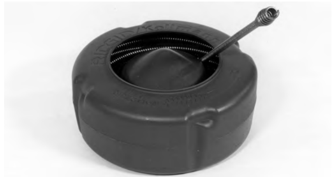
Figure 19 – Lors de l'enroulement du câble dans le tambour interne, tournez-le à DROITE
