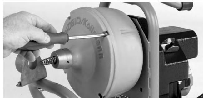
Figure 16 – Desserrer les 4 vis de tambour de 3 tours complets, mais sans les enlever.
