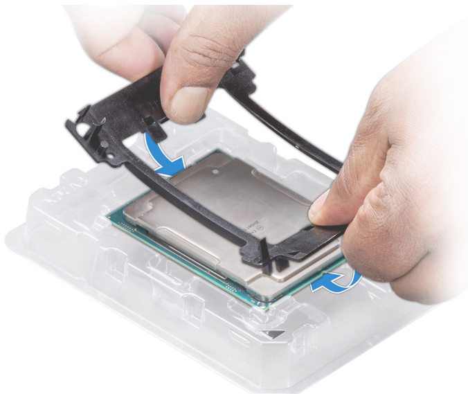
Figure 34. Installation du support de processeur
