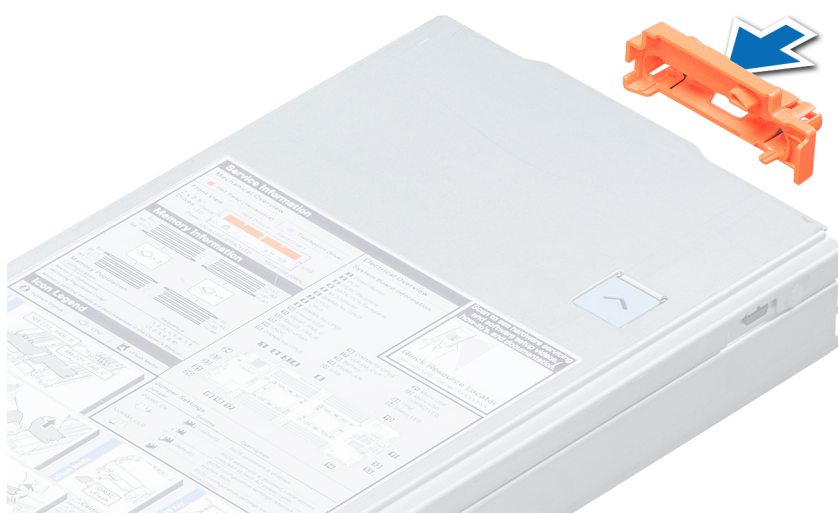
Figure 8. Installation du cache de connecteur d'E/S.
