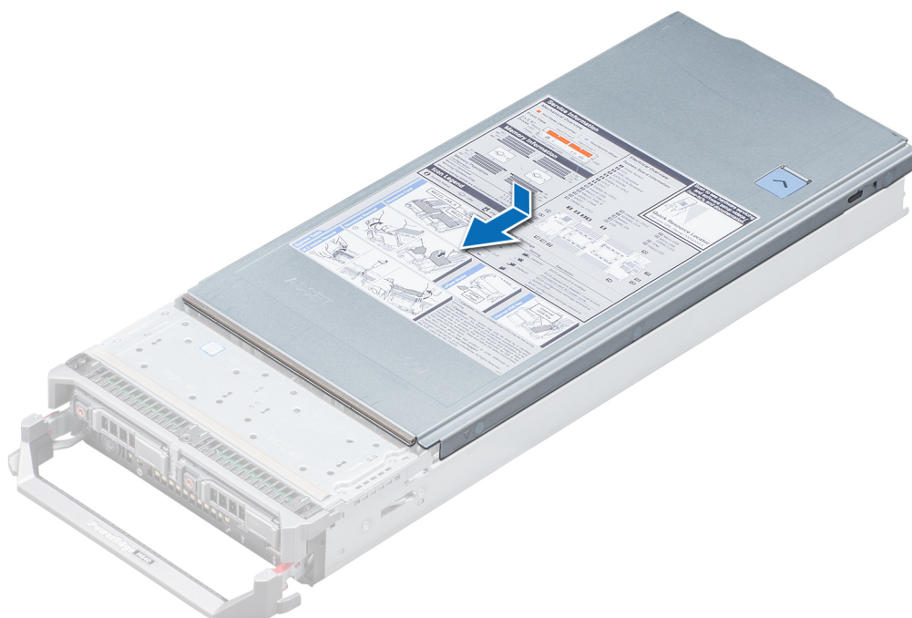
Figure 13. Installation du capot du système
