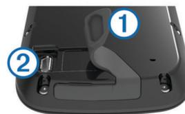
2 Introduza a extremidade pequena do cabo USB na porta USB do dispositivo.
