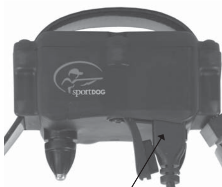
EL CONECTOR DEL CARGADOR COLOCADO EN LA TOMA DE CARGA DEL COLLAR RECEPTOR
