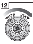
Oberen Kegel einrasten lassen
