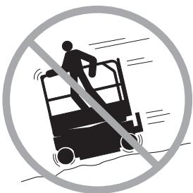
Adapte la velocidad de desplazamiento al estado e inclinación del suelo, a la congestión del lugar, a la ubicación del personal y a cualquier otro factor que pueda ser causa de una colisión.
