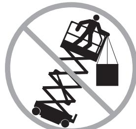
No coloque ni enganche cargas fijas ni sobresalientes a ninguna parte de la máquina.
