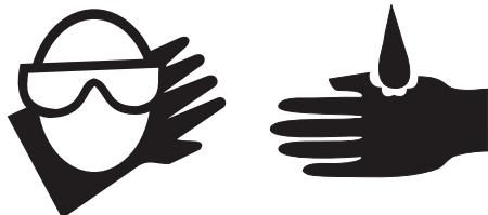
Evite derramar y tocar el ácido de las baterías. Neutralice cualquier vertido accidental de ácido con bicarbonato sódico y agua.
