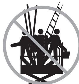
No coloque escaleras ni andamios en la plataforma ni los apoye en ninguna parte de la máquina.
