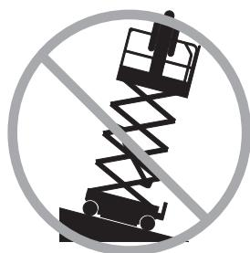
No eleve la plataforma si la máquina no se encuentra sobre una superficie firme y nivelada.
