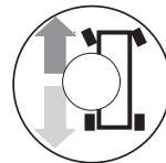
Para reducir la velocidad: Desplace lentamente la palanca de mando hacia el centro.
