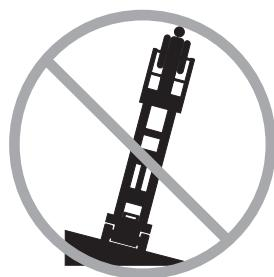
No confíe en la alarma de inclinación como indicador de nivelación. La alarma de inclinación suena en el chasis sólo cuando la máquina se encuentra en una pendiente muy pronunciada.
