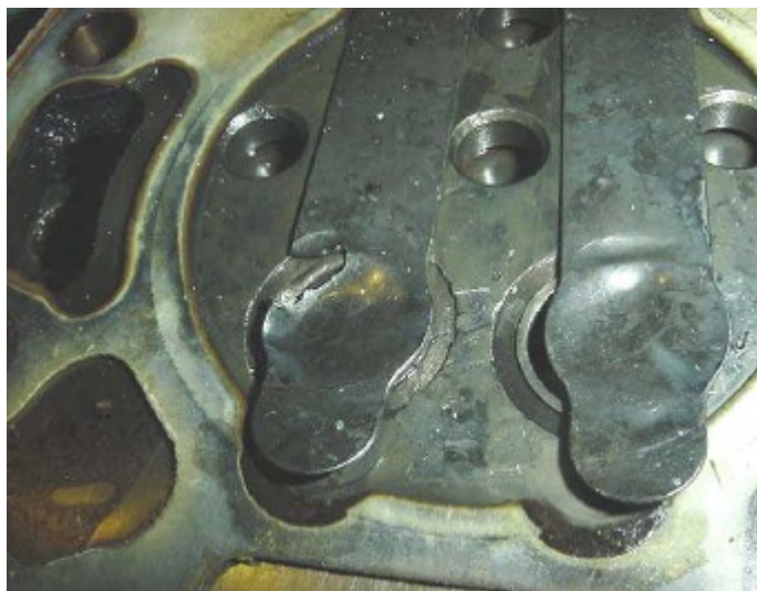
Figura 20: Válvulas danificadas por golpe de líquido (Silva, 2004).
