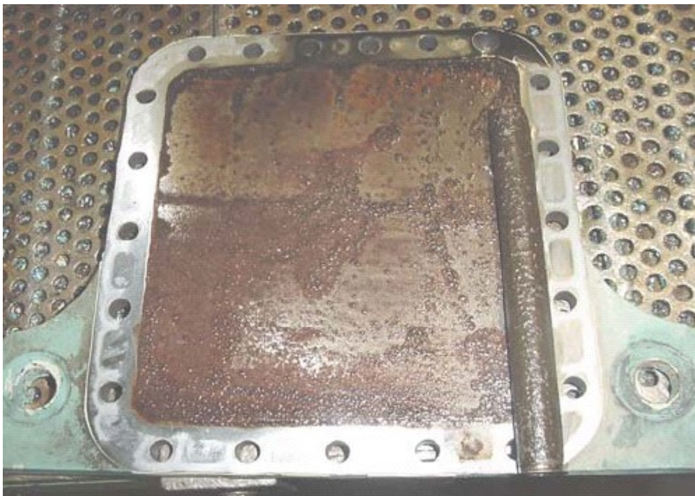
Figura 26: Filtro de óleo entupido por óxidos (Silva, 2004).
