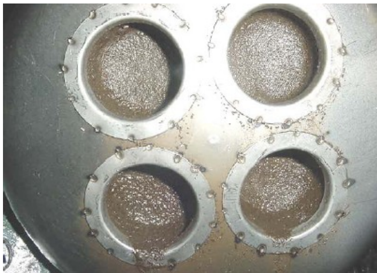
Figura 25: Filtros de sucção entupidos (Silva, 2004).
