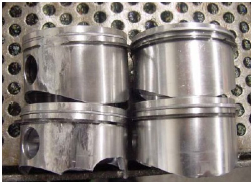
Figura 17: Pistões desgastados por Retorno de líquido (Silva, 2004).
