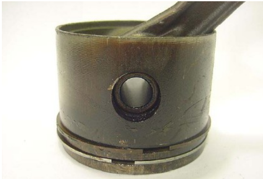
Figura 23: Pistão com óleo carbonizado (Silva, 2004).
