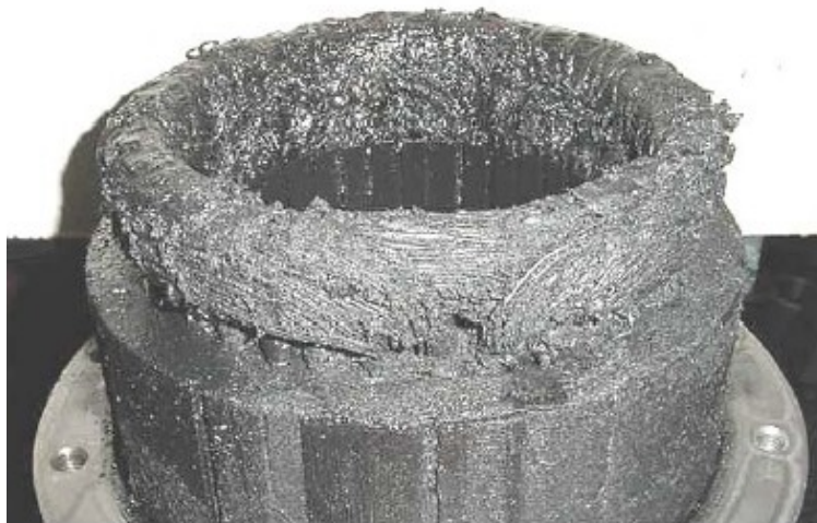
Figura 28: Motor queimado (Silva, 2004).
