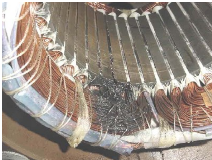
Figura 29: Queima de um único ponto do enrolamento do motor (Silva, 2004).
