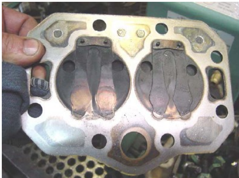
Figura 22: Válvulas carbonizadas (Silva, 2004).
