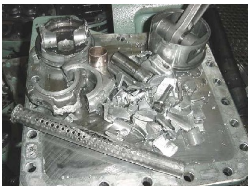
Figura 21: Danos resultantes de um golpe de líquido (Silva, 2004).
