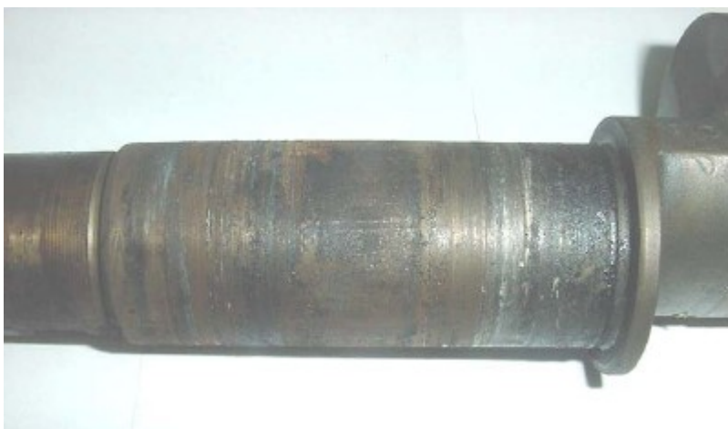
Figura 19: Virabrequim com sinais de desgaste por problemas de lubrificação (Silva, 2004).
