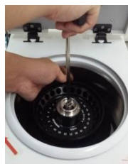
Outil du rotor sans écrou
