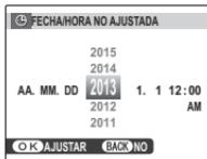
**2.1** Pulse el selector hacia la izquierda o hacia la derecha para resaltar el año, mes, día, horas o minutos y púlselo hacia arriba o hacia abajo para cambiar los valores mostrados. Para cambiar el orden en el que se visualiza el año, mes y día, resalte el formato de fecha y pulse el selector hacia arriba o hacia abajo.
