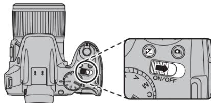
Deslice el interruptor **ON/OFF** para apagar la cámara.
