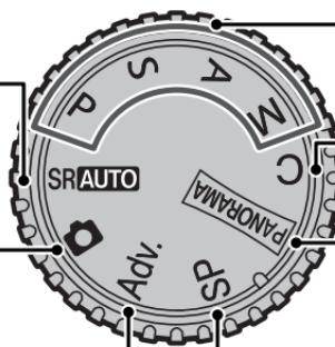
**P, S, A, M:** Seleccione estas posiciones para tener el control total de los ajustes de la cámara, incluida la abertura (M y A) y/o la velocidad de obturación (M y S) (§ 31).
