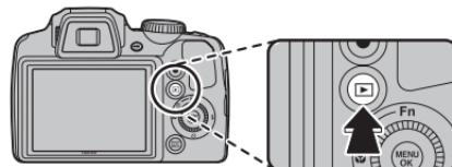
Pulse nuevamente el botón **■** o deslice el interruptor de **ON/OFF** para apagar la cámara.
