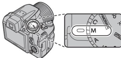
Pulse el botón
