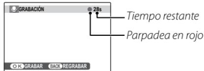
**3** Pulse **MENU/OK** nuevamente para finalizar la grabación. La grabación finaliza automáticamente al cabo de 30 segundos.
