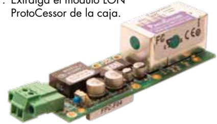
2. Inserte el módulo LON ProtoCessor en las patillas de la placa de control Vapor-logic.
