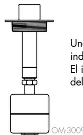
Una marca cero en la parte superior del flotador indica la posición correcta del flotador en el vástago. El interruptor está normalmente abierto cuando la bola del flotador está en su punto más bajo en el vástago.
