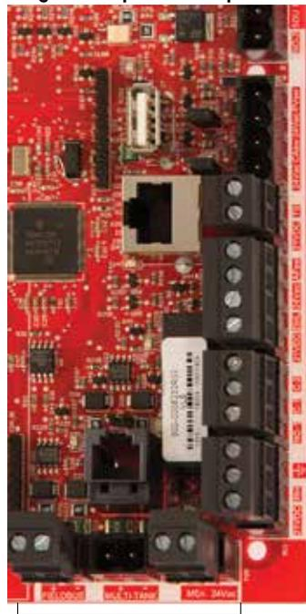
— Terminales de conexión de campo. Los terminales P-11 a P-16 tienen un borde blanco en la placa de control Vapor-logic. Aquí es donde realizará la mayoría de las conexiones de cableado de campo.
