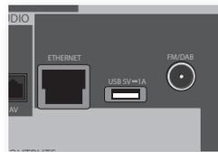
L'AVR est équipé d'un client audio en réseau capable de faire passer des stations de radio internet aussi bien que de la musique enregistrée sur un périphérique de stockage réseau, tel qu'un PC ou une clé USB.
