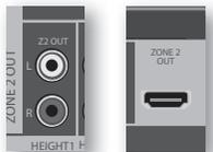
Le connecteur HDMI de la sortie Z2 peut servir à raccorder la sortie de l'AVR à un système situé dans une seconde pièce.
