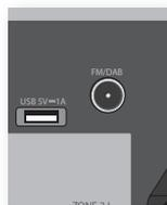
*Dans des régions où le signal est puissant*, l'antenne filaire DAB/FM « T » fournie peut servir. Montez l'antenne le plus haut possible sur un mur.
