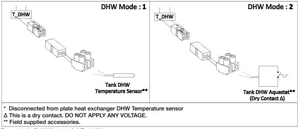
Figure 11.12: DHW Modes 1 & 2 Tank Wiring
