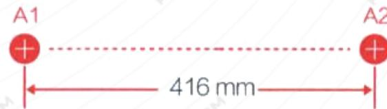
Выберите точку A1 на стене, в соответствии с пожеланием расположения аудиосистемы. Проведите линии в соответствие с уровнем, и на расстояние 416мм справа отметьте точку A2.
