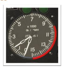
2TE15-1 ENGINE SPEED (TACHOMETER)
