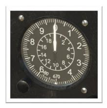
VD-20 BAROMETRIC ALTIMETER
