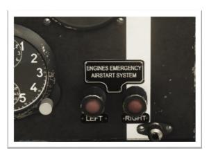
ENGINE AIR RE-LIGHT SYSTEM LAMPS
