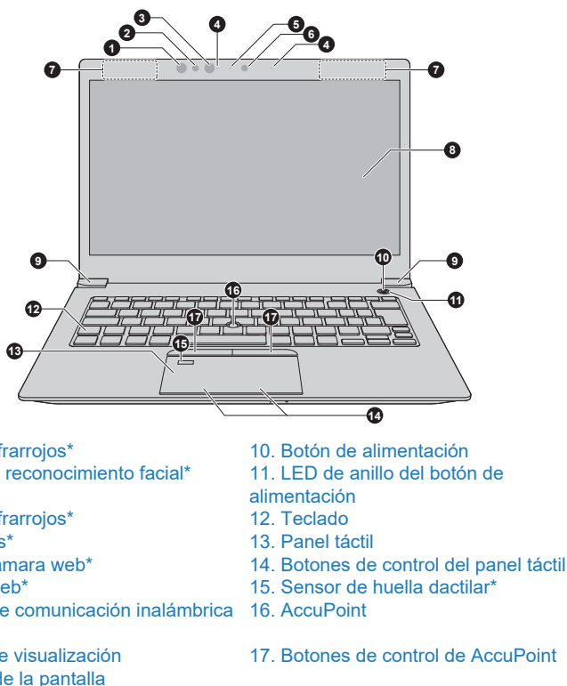
Figura 3-6 Parte frontal del ordenador con el panel de visualización abierto
