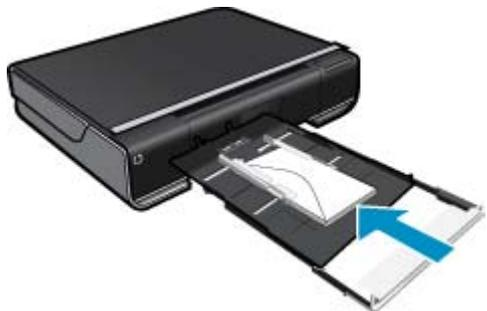
Insira a pilha de envelopes no centro da bandeja de papel com a borda curta para frente e o lado de impressão voltado para baixo. Empurre a pilha para frente para dentro da bandeja até ela parar. Deslize as guias de largura de papel para dentro até elas encostarem na borda do papel. Feche a bandeja principal.
