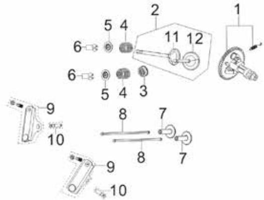
**Fig. 6 - Valve Train & Camshaft Subassembly**
