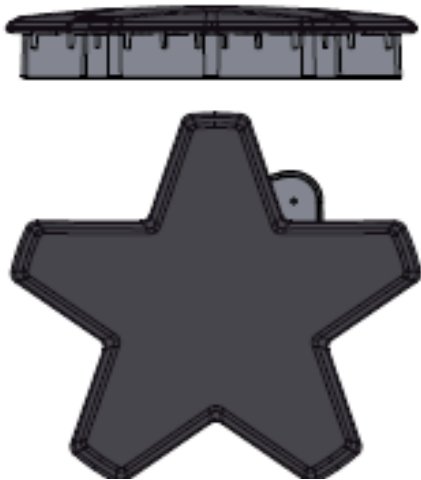
Figura 14: Tapa de quemador colocado correctamente
