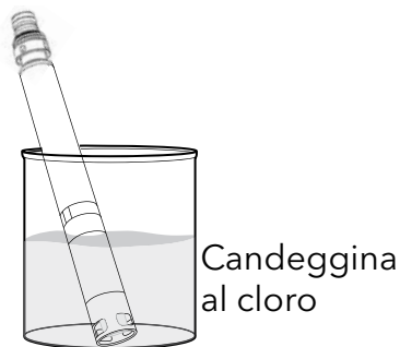
Figura 74 Pulizia del sensore pH e pH/ORP con candeggina al cloro
