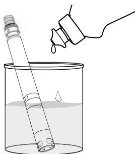
Figura 72 Pulizia del sensore pH e pH/ORP con sapone per i piatti
